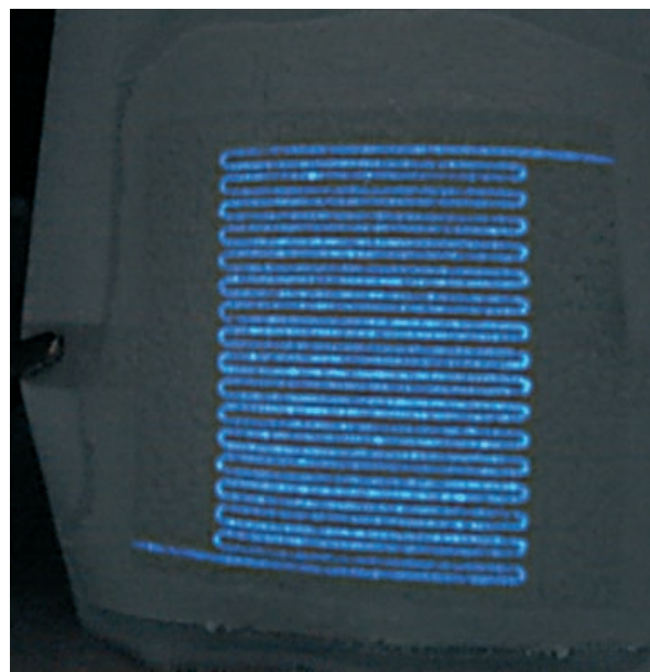
Elektrolumineszenz für den Notfall (Quelle: ITCF)
