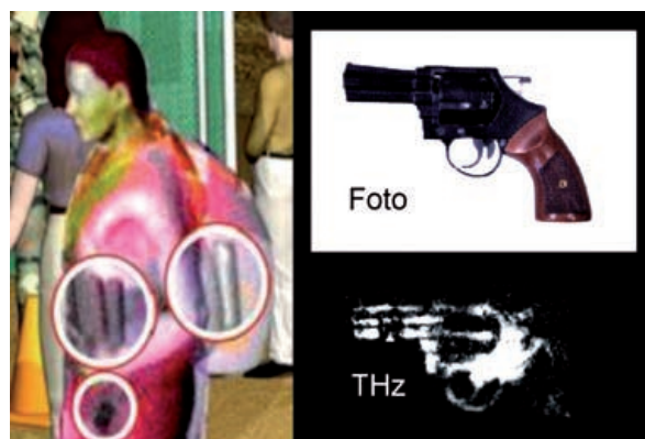
Checkpoint-Szenario und experimentelles, in zehn Sekunden aufgenommenes THz-Bild einer unter Kleidung verborgenen Waffe (Quelle: GE (links); Uni-FFm / RPG)
